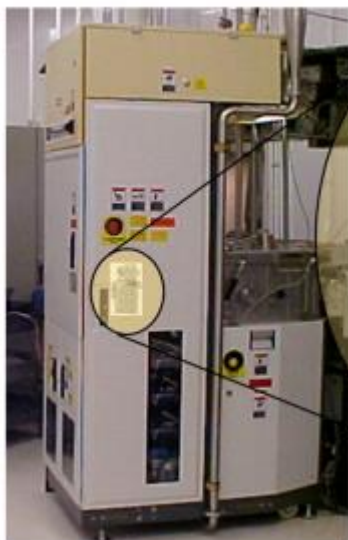
Links: de in 2007 geïntroduceerde Pulsar 3000; Rechts: de Pulsar XP, ASMI's meest geavanceerde ALD-machine
